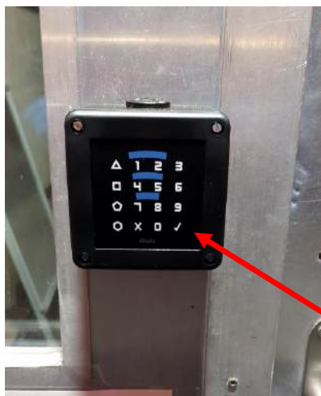
FIGURE 18 – boîtier à code avec bouton « valider » (gauche) | sens pour tourner la serrure une fois le code entré (droite)
